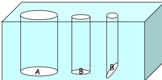
Fig.11.1 Il peso d'acqua che una superficie deve sopportare a una data profondità dipende da quanto la superficie è estesa, ma anche da come è orientata. Se la superficie B è orizzontale, la colonna d'acqua che la sovrasta è grande, se B è inclinata, la colonna d'acqua diventa più sottile, quindi più leggera.
