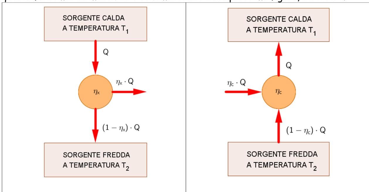
La parte destra della figura schematizza il comportamento della macchina di Carnot: essendo reversibile viene fatta funzionare al contrario, cioè come frigorifero che sottrae calore alla sorgente fredda per riversarlo in quella calda.
