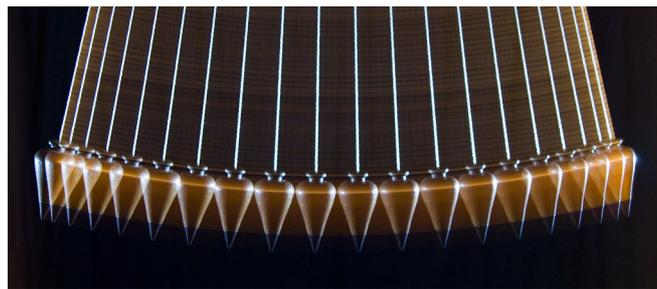
Fig.29.6 Foto stroboscopica dell'oscillazione di un pendolo
