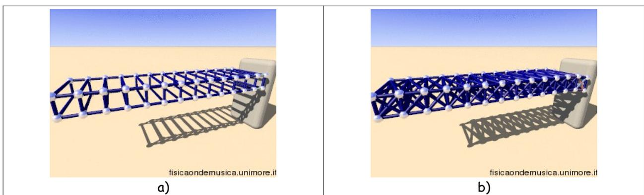
Fig.29.5 Propagazione di un'onda: a) longitudinale b) trasversale ([CLICCA](#))
