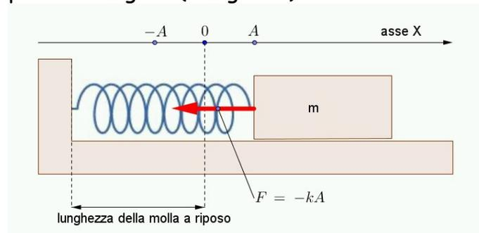
Fig.29.1 Condizione iniziale di un sistema massa - molla
