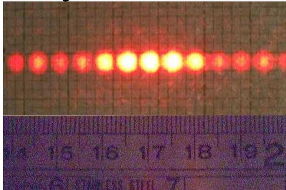
Le note si dimenticano di citare un dato importante: la distanza  $D$  che separa il reticolo dallo schermo sul quale si forma l'immagine che vediamo. Sapreste valutare questa distanza, prendendo per buone le note citate, e misurando la distanza tra i massimi con il righello che vedete riprodotto?
